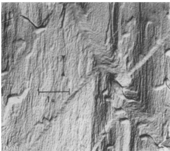
Abb. 9. Überstruktur einer Deformationsbande in Nylon
