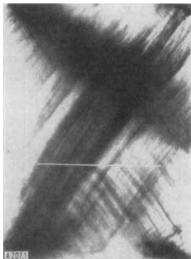
Abb. 1. Deformationsbänder in Nylon 6.10. Länge des weißen Striches: 1 mm.
